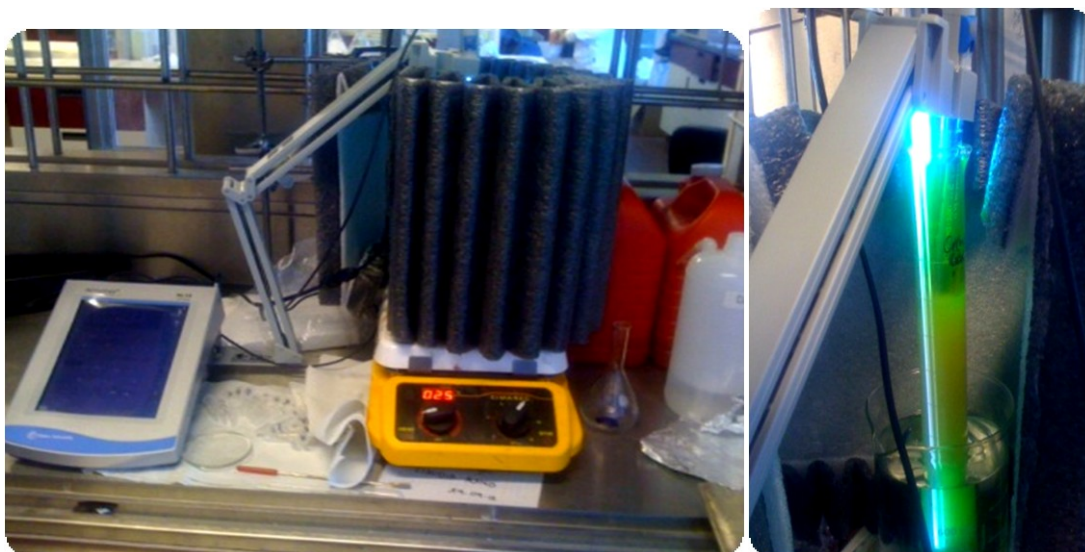
Figura 9. Configuración del sistema de reacción: Reactor, Baño de agua, Agitador magnético, Parrilla de agitación y potenciómetro.
